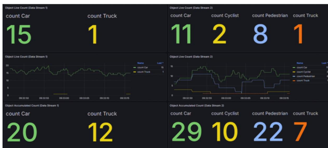
Abbildung 7 Dashboard mit Zählung der erfassten Objekte in zwei Datenströmen (links und rechts). Gezeigt wird sowohl die Live erfasste Anzahl an jeweiligen Objekten (oben), als auch die Werte für die gesamte Session (Mitten, unten).
